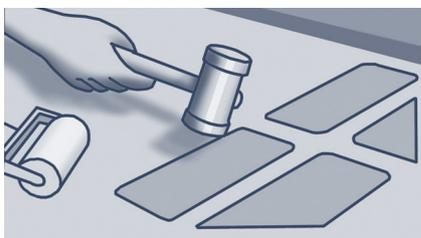
5. Benutzen Sie den Handandruckroller, um eine feste Verbindung und gute Anfangshaftung zu erzielen. Für die Verlegung von 3M Safety-Walk Verformbar sollten Sie zum Andrücken auch einen Gummihammer verwenden, um das Material der strukturierten Oberfläche anzupassen.
