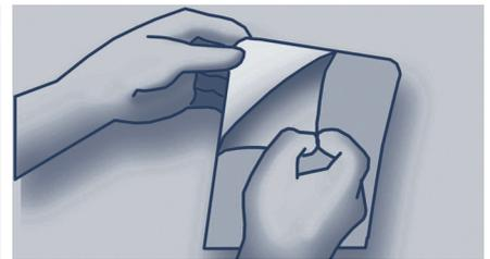
3. Enden eines Safety-Walk Stückes umbiegen. Schutzliner teilweise abziehen und 3M Safety-Walk passend verlegen. Den Kleber nicht berühren. Auf Treppen 3M Safety-Walk im Abstand von 12-15 mm von der Vorderkante der Stufe verlegen, um ein Beschädigen der Ränder zu vermeiden.
