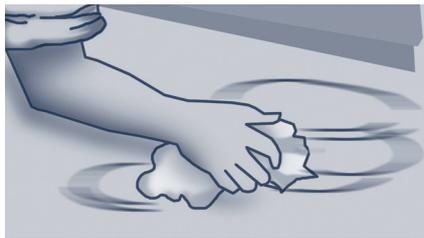
1. Reinigen Sie die Oberfläche mit einem Grundreiniger von Fett- und Schmutzresten. Gründlich mit Wasser nachspülen und vollkommen abtrocknen lassen. Die Minimum-Verlegetemperatur für eine korrekte Verlegung beträgt 4 °C (10 °C für Typ Nasszone, fein).
