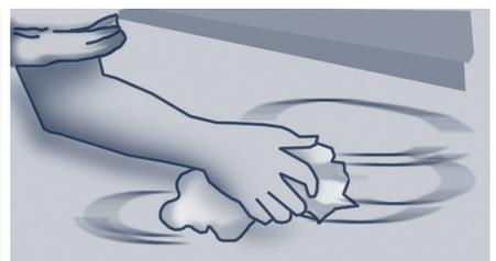
6. In Nasszonen empfehlen wir, die Kanten des 3M Safety-Walk Nasszonenbelags mit dem 3M Safety-Walk Kantenschutz zu versiegeln, um ein Eindringen von Feuchtigkeit auszuschließen. Achten Sie darauf, dass der Kantenschutz sowohl das Antirutschmaterial als auch den Untergrund abdeckt. Nach der Trocknung des Kantenschutzes (etwa 30 Minuten) kann die Fläche wieder betreten werden.
