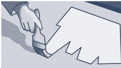
2. Auf porösen oder rauen Oberflächen (wie unbehandeltem Holz, Beton oder Naturstein) zuvor 3M Grundierung (z. B. 3M Scotch-Weld Tape-Primer 83 oder 3M Primer 94) mit einem Pinsel an exakt der Stelle auftragen, auf der Safety-Walk verlegt werden soll. Grundierung antrocknen lassen.
